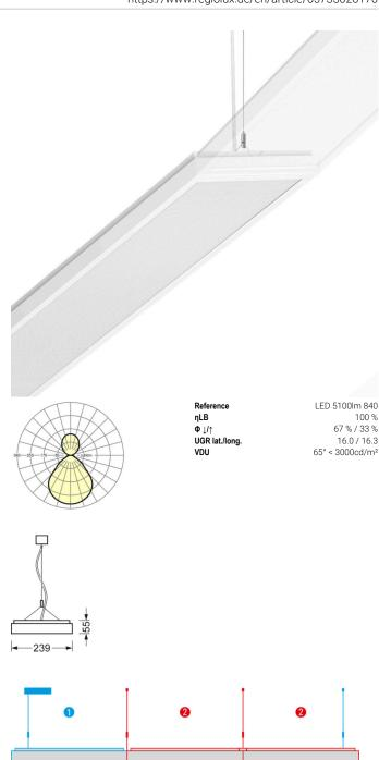
1 Pendel-Einzelleuchte / Suspended individual luminaire
